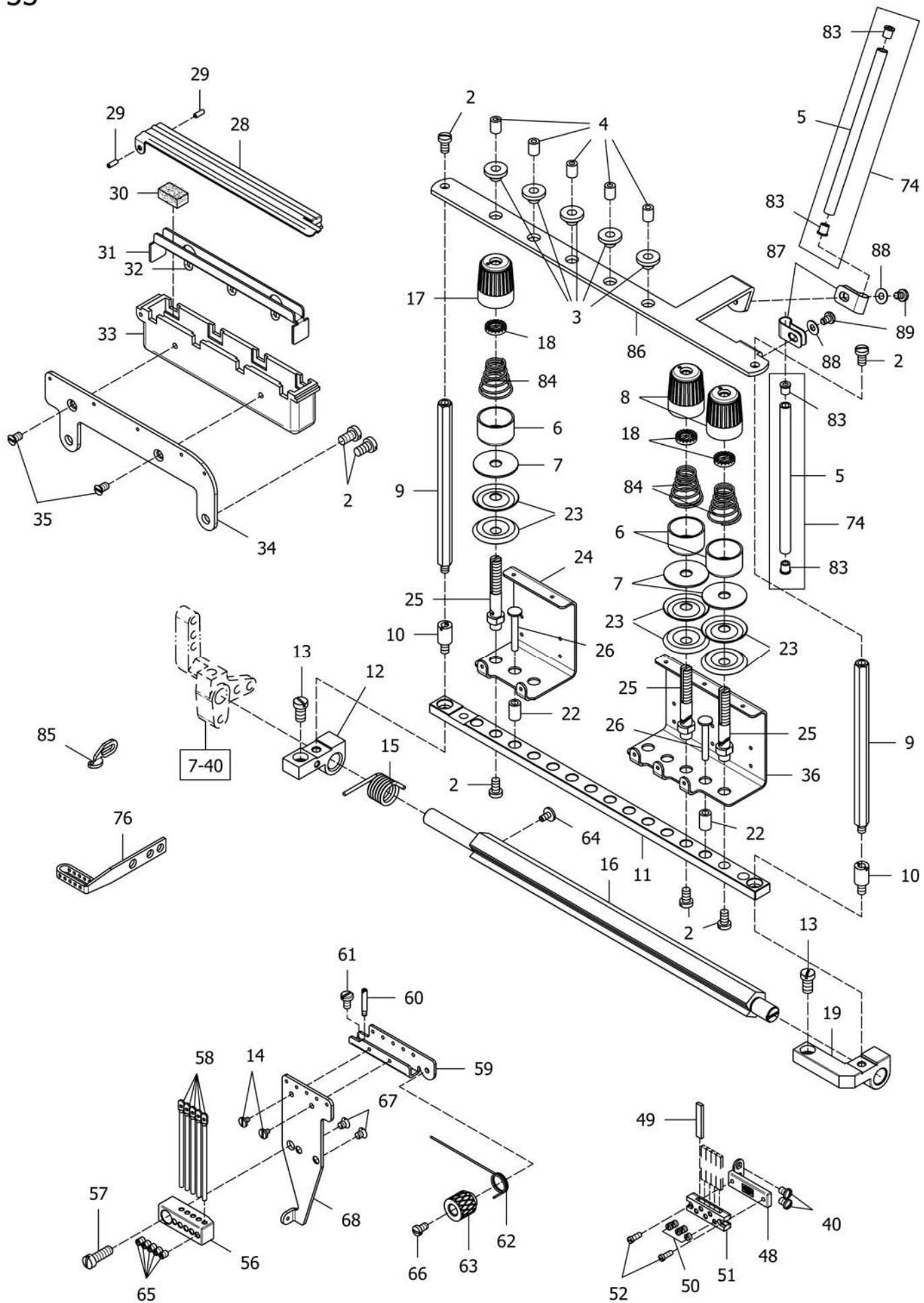
SELECT DEVICE(MISCELLANEOUS THREAD EYELETS-5NEEDLE) 選擇配備(過線機構-五針七線) 33
