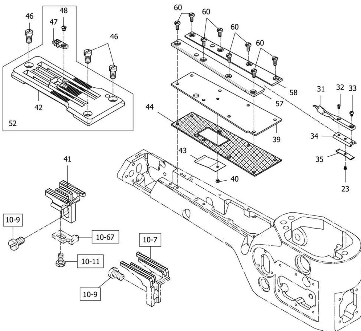
**DOUBLE SIDE CUT PRESSER FOOT MECHANISM****雙切押腳機構****18**
